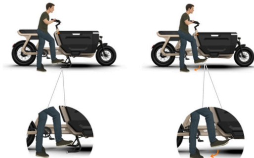
Figure 6 • Déplier la béquille centrale
