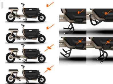
Afbeelding 7 • Goede en verkeerde standen van de standaard
