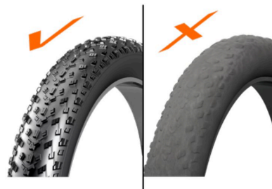
Afbeelding 14 • Goed en versleten bandprofiel
