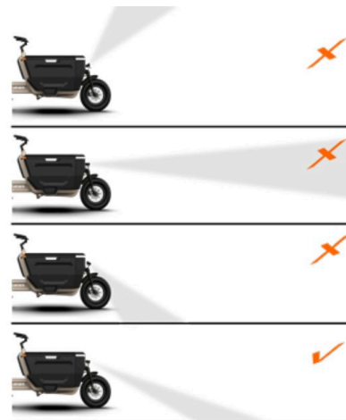
Abbildung 4 - Richtige Einstellung des Scheinwerfers
