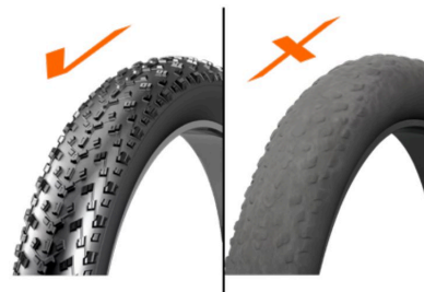
Abbildung 14 • Gutes und abgefahrenes Profil
