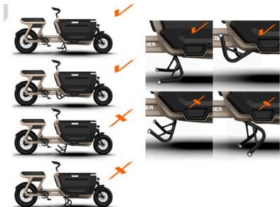
Abbildung 7 • Richtige und falsche Ständerpositionen
