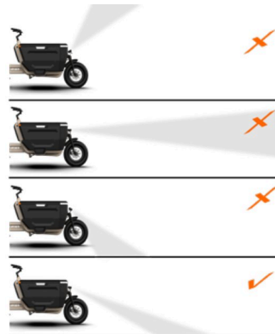
Afbeelding 4 • Juiste stand van de koplamp
