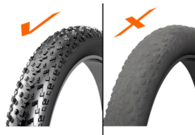
Figure 14 · Bande de roulement en bon état et usée
