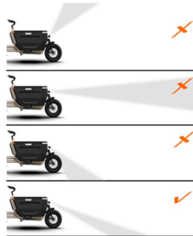
Bild 4 • Rätt inställning av strålkastaren
