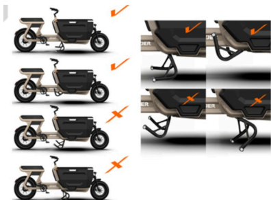
Figura 7 • Posiciones correctas e incorrectas del caballete
